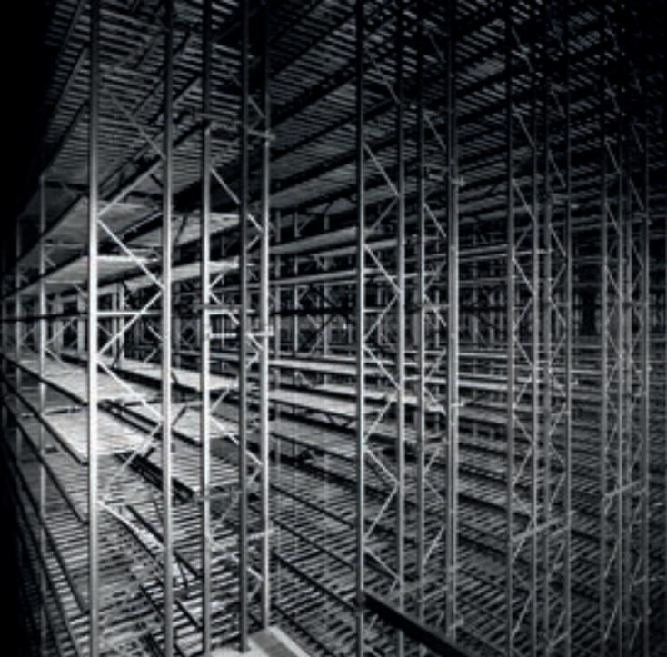
control de rotación de stocks y el ahorro de espacio. Es una estructura compacta en la que se incorporan camas de rodillos sobre las que se deslizan las unidades de carga gracias a una pequeña inclinación o un carro que se desplaza sobre raíles con una inclinación positiva.
